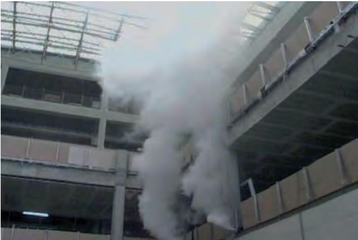
Abbildung 42: Entrauchungsversuch zur Verbesserung des Brandschutzes
